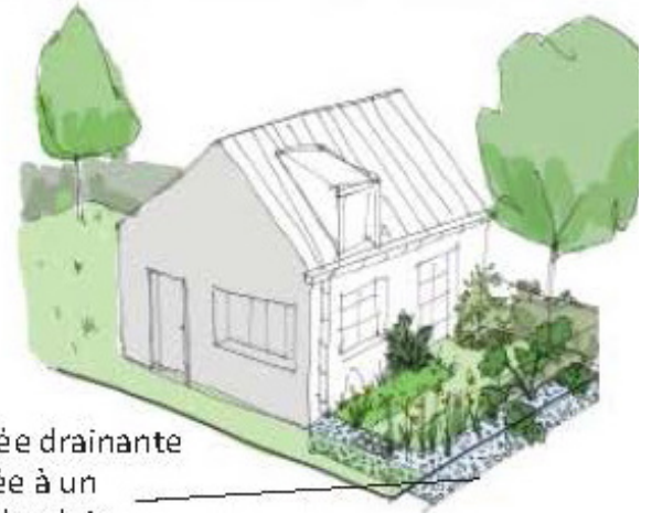
Exemple d'une tranchée drainante associée à un jardin de pluie
